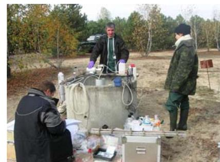
*Prélèvement d'eaux souterraines sur le site
